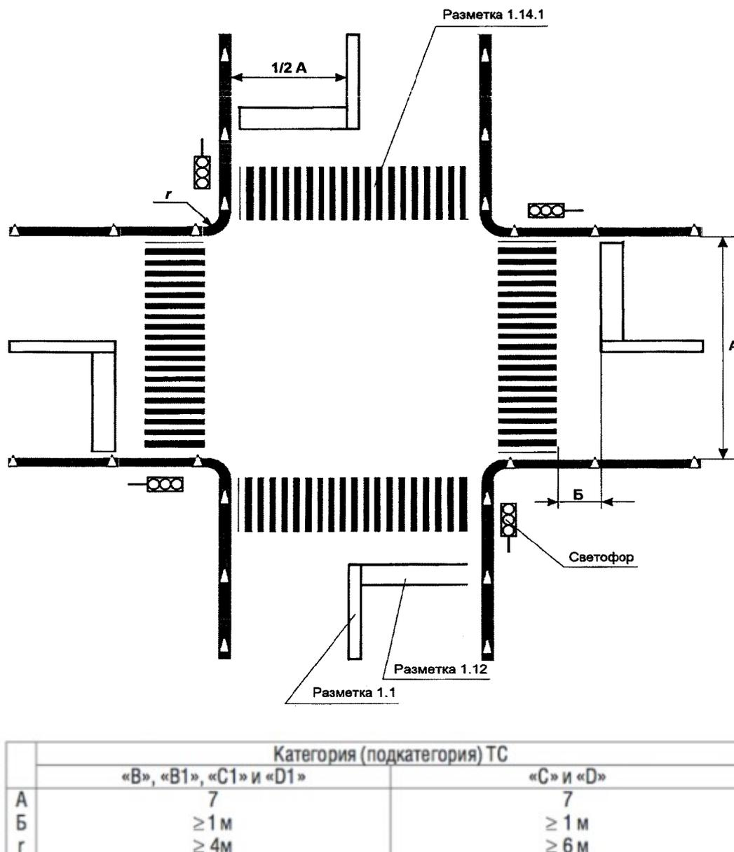
Рисунок 13. Схема и размеры упражнения N 8
